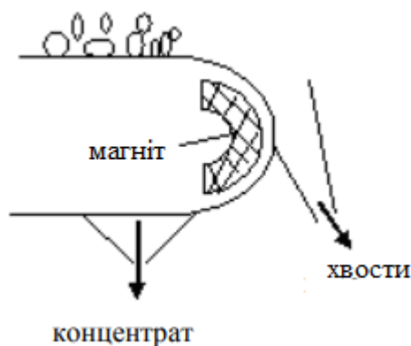
Рисунок 3.5 Схема магнітної сепарації
