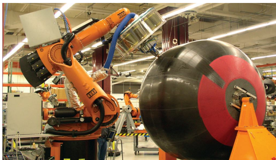
Рис. 3.5 Изготовление композитного бака жидкого водорода [4]
