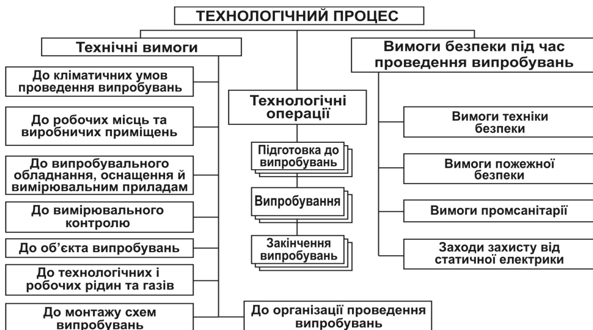
Рис. 2.2. Структурна схема технологічного процесу випробувань
