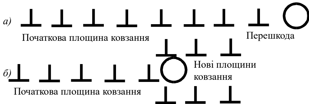
Рис. 2 Схема додання перешкод при пересуванні дислокацій в умовах повзучості: а) невеликі температури; б) значні температури.
