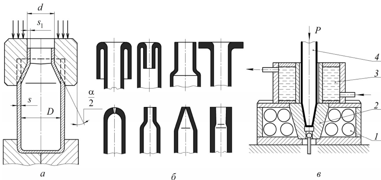
Рис. 3.49. Схема обтиску (а), різноманітні кінцеві ділянки трубних заготовок, одержані обтиском і роздачею (б), принципова схема обтиску кінцевої ділянки трубної заготовки (в): 1 – елементи для нагрівання; 2 – матриця; 3 – холодильник; 4 – заготовка
