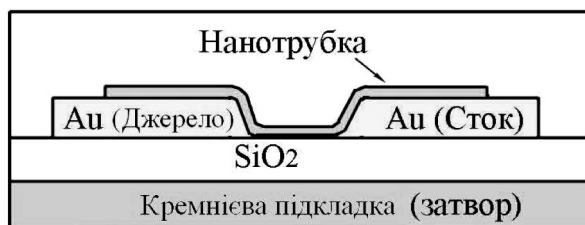
Рис. 4.1 Схема польового транзистора на основі вуглецевої нанотрубки
