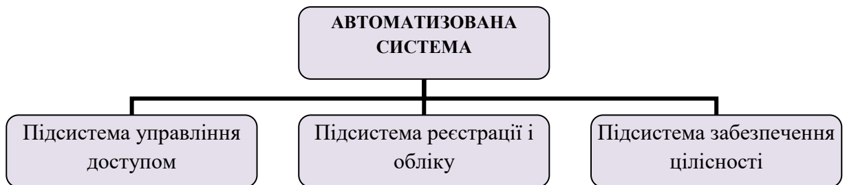
Мал. 3.2.1 Підсистеми управління та забезпечення захисту інформації в автоматизованих системах
