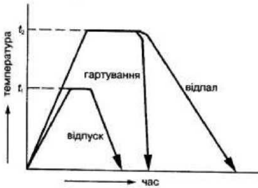
Рис. 4.1. Схематичне зображення різних операцій термічної обробки
