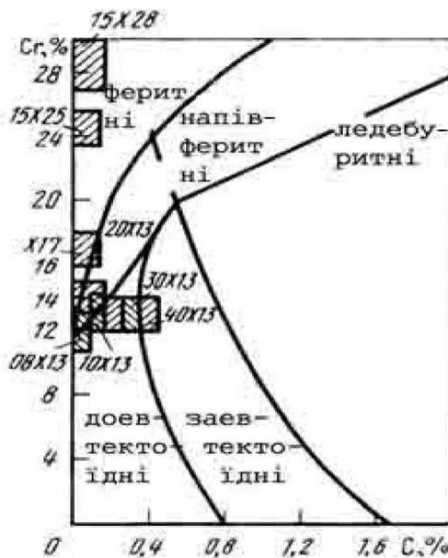
Рисунок 2.1 - Структурні класи сталей в системі Fe-Cr-C та положення на діаграмі промислових хромистих сталей
