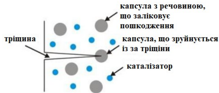
Рисунок 4.14. Самовідновлення матеріалу з капсулами з речовиною, що заліковує пошкодження.
