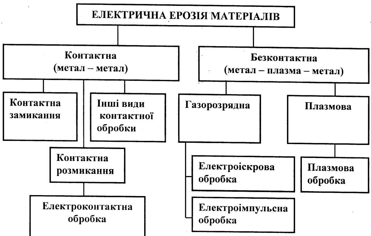
Рис.7. Види електроерозійної обробки
