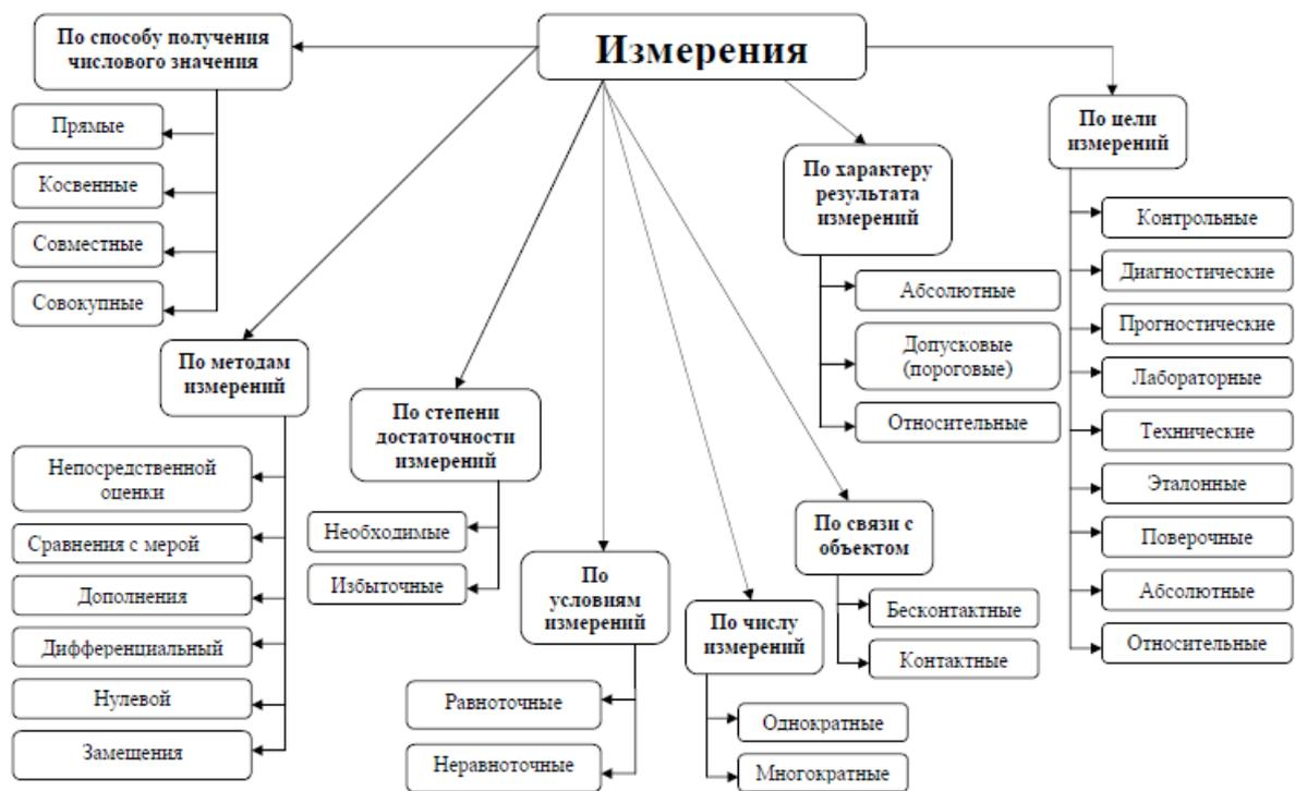
Рис. 1 Классификация видов измерений
