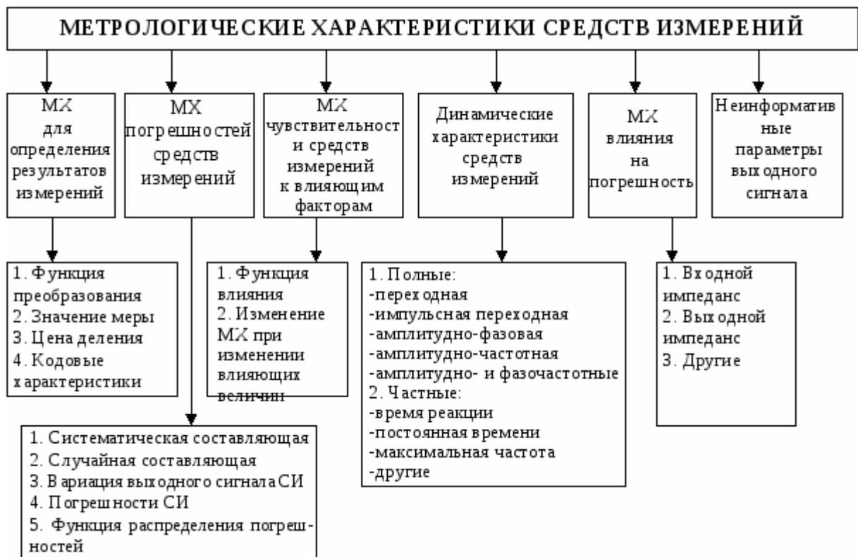
Рис. 10.6. Номенклатура метрологических характеристик средств измерений
