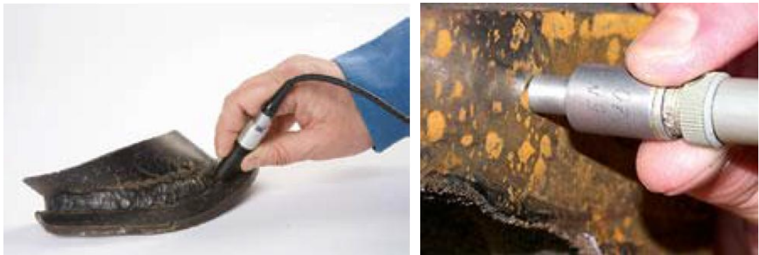
Рис 9.5 Проведение вихретокового контроля по грубой поверхности
