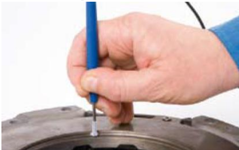
Рис. 9.6 Проведение вихретокового контроля в труднодоступных местах с использованием преобразователей изогнутой формы.
