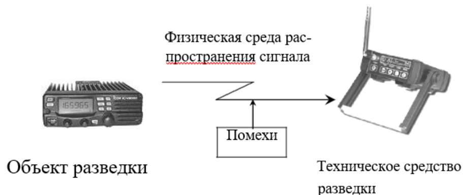
Рис. 1 Технический канал утечки информации
