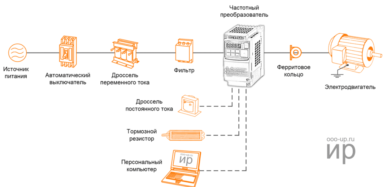
Рис. 12 – Функциональная схема частотно-регулируемого привода
