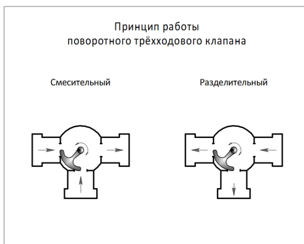
Рис. 5 – Принцип действия трёхходового клапана поворотной конструкции
