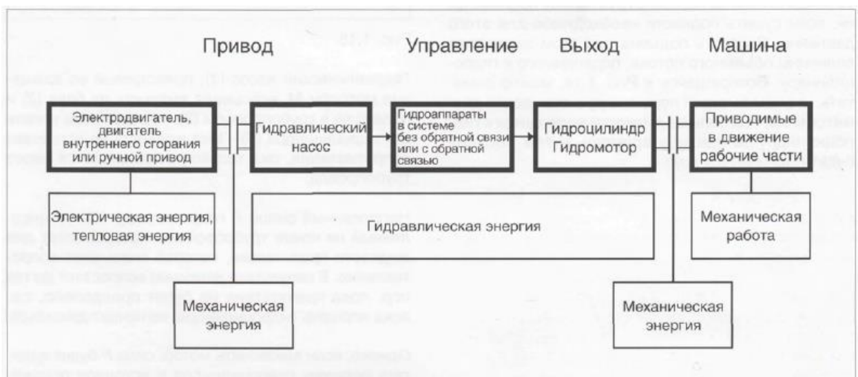
Рис. 21.5 – Передача энергии в гидроприводе
