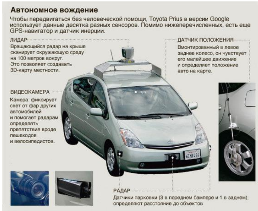
Рис. 4 – Принцип работы беспилотного автомобиля Toyota Prius в версии Google.
