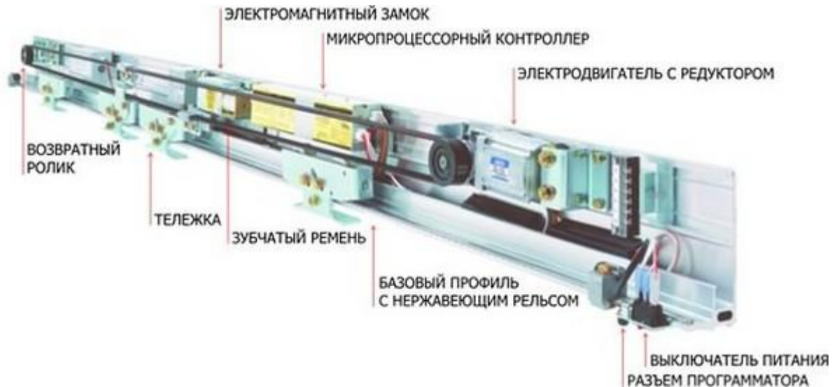
Рис. 2 – Исполнительное устройство автоматических дверей.
