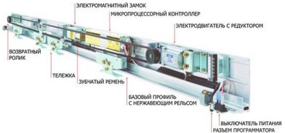
Рис. 2 – Виконавчий пристрій автоматичних дверей.
