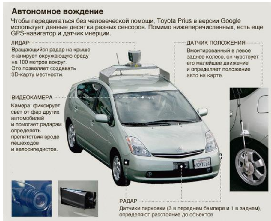
Рис. 4 – Принцип роботи безпілотного автомобіля Toyota Prius в версії Google.
