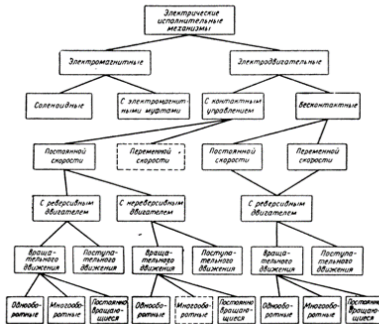
Рисунок 11.2 Классификация электрических исполнительных механизмов
