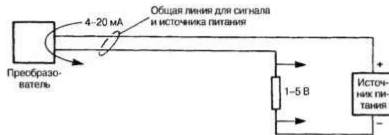
Рис. 2. Двухпроводным преобразователь 4-20 мА
