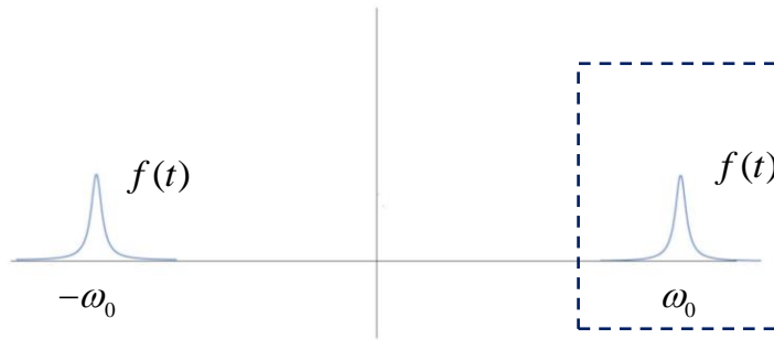
Рис. 8 Спектр сигналу f(t) , який є результатом множення сигналу s(t) на гармонійний сигнал g(t) = \cos(\omega_0 t + \varphi_0)
